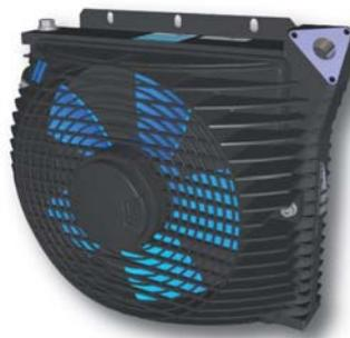
Enfriador de aceite mediante corriente de aire hasta 250 l/min. Incluye de serie el relé, termostato (fijado a 47°) y el kit de conexiones.
