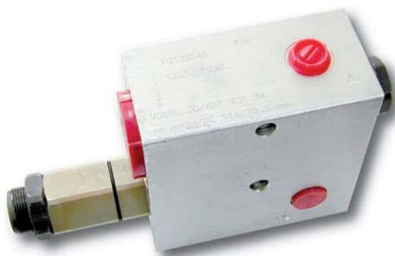
Especial para descarga de piedras. La válvula actúa primero abriendo el portón trasero y después da paso al volteo del volquete. Esto evita que la carga choque de golpe contra el portón. Funciona a través de un cartucho hidráulico que actúa por diferencia de presiones.
