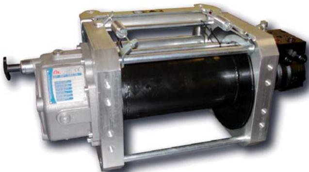
Cabrestante de arrastre hidráulico de reducción de planetarios en 2 etapas con tambor de gran capacidad. Bidireccional, con válvula overcenter y freno mecánico de emergencia con retención del 100%.
