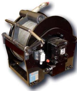
Cabrestante hidráulico de elevación hasta 2500 kg. Con sentido de giro a izquierdas, freno negativo multidisco y lubricación interna.
