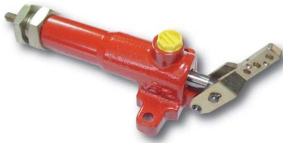
El regulador automático de giro, tiene la función de pilotar mecánicamente el giro del motor, cuando la necesidad operativa del equipo hidráulico ha de estar al mínimo sin pausa de trabajo. Existen diversos campos de funcionamiento como grúas, excavadoras, equipos basureros, etc... . Entre sus ventajas destacan la reducción de ruidos, emisiones medioambientales y consumo de carburante.
