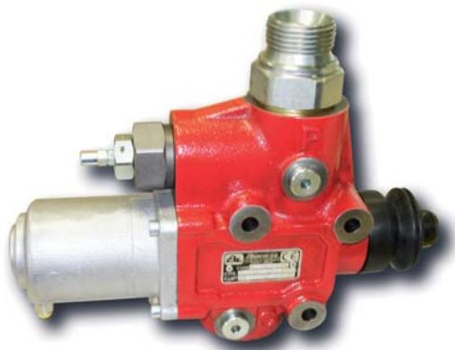
Válvula para volquete, centro abierto proporcional de 250 litros con accionamiento neumático, válvula limitadora de presión ajustable. Incorpora válvula antirretorno de pistón, final de carrera mediante tirador o empujador, indicador de funcionamiento opcional,toma de presión y presostato
