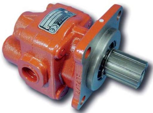
Bomba de engranajes con sentido de giro reversible y drenaje interno. Puertos traseros y laterales.
