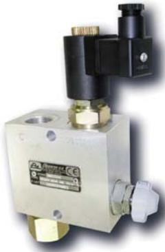
Válvula de descenso regulable para volquete de centro abierto y cerrado. Incluye válvula de seguridad y se puede ajustar el tarado de presión hasta 250 bar.
