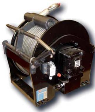
Cabrestante hidráulico de elevación hasta 4500 kg. Con sentido de giro a izquierdas, freno negativo multidisco y lubricación interna.
