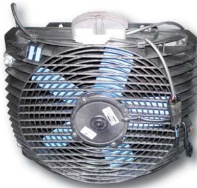
Enfriador de aceite mediante corriente de aire hasta 150 l/min. Incluye de serie el relé, termostato (fijado a 47°) y el kit de conexiones.
