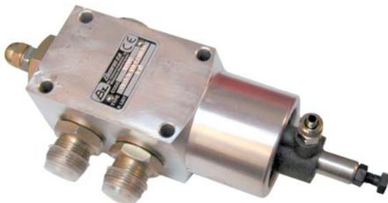
Válvulas construidas sobre cuerpo de aluminio con 2 caudales: 100 y 150 litros. Son ligeras, versátiles, económicas y de fácil montaje. Se pueden montar en línea (final de carrera) o en el depósito (placa base).
