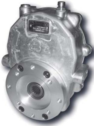
Caja multiplicadora especial para tractor con diferentes tipos de salida (SAE B, SAE BB, ISO). Fabricada en Aluminio templado de alta resistencia . Con rodamientos de rodillos cónicos.
