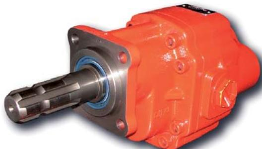
Bombas de engranajes con cuerpo reforzado, puertos laterales y traseros. Doble rodamiento cónico para apoyo del eje agrícola de tipo 1 con longitud modificada.
