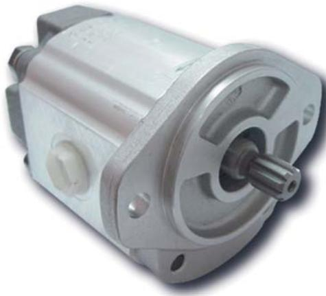
Bomba de engranajes con sentido de giro reversible y drenaje interno. Construida con cuerpo de aluminio, más ligera y que permite trabajar a altas presiones con un bajo nivel de ruido. Con brida SAE "A" 9 dientes.
