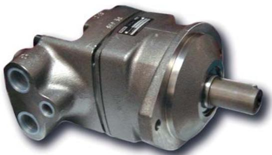
La serie F11 es una bomba-motor con eje en ángulo y caudal fijo para aplicaciones fuertes. Puede emplearse tanto en aplicaciones de circuito abierto como en circuito cerrado. Cumple con las normas ISO y SA sobre brida de montaje y eje. También disponible en versión tipo cartucho, con una longitud de instalación reducida.
