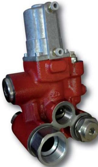
Valvula de volquete de centro abierto proporcional para 150 litros acoplado a bomba, con accionamiento neumático y válvula limitadora de presión. Evita montar el latiguillo de retorno a tanque, efectuando la descarga a través de la linea de alimentación. Permite cambiar la configuración para ambos sentidos de giro de la bomba y permitiendo también su rotación 180° para eliminar interferencias.
