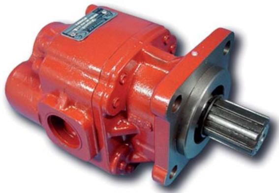
Bomba de engranajes bidireccional de alta presión con puertos laterales y traseros que le da amplias posibilidades de montaje , disponibles con bridas ISO 4 taladros y SAE 2/4 taladros. Presiones de trabajo continuo hasta 290 bar.
