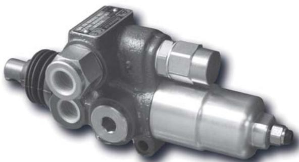
Válvula para volquete, centro abierto proporcional o centro cerrado de 2 velocidades de bajada de 70 litros con accionamiento neumático o mecánico, con válvula limitadora de presión ajustable hasta 350 bar. Incorpora válvula antirretorno, final de carrera mediante tirador y también un interruptor de funcionamiento opcional.
