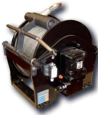
Cabrestante hidráulico de elevación hasta 3550 kg. Con sentido de giro a izquierdas, freno negativo multidisco y lubricación interna.
