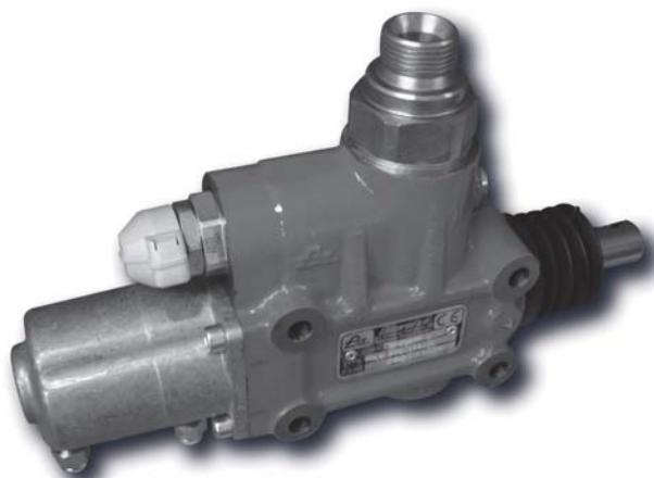
Válvula para volquete, centro abierto proporcional o centro cerrado de dos velocidades de bajada de 150 litros con accionamiento neumático, con válvula limitadora de presión ajustable hasta 350 bar. Incorpora válvula antirretorno, final de carrera mediante tirador o pulsador, presostato de funcionamiento opcional y toma de presión.
