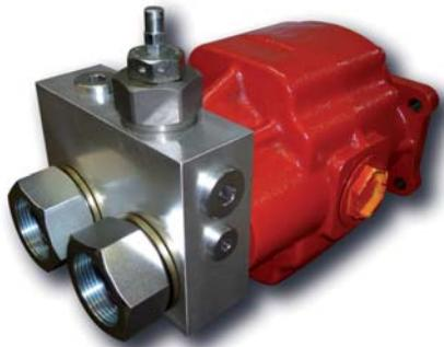
Válvula limitadora con cuerpo de aluminio para acoplar a la serie XL de las bombas BE. Descarga el exceso de presión acumulado en la línea de presión hacia la línea de alimentación, evitando el desgaste innecesario de los latiguillos y demás componentes del circuito.
