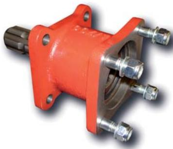
Kit adaptador para convertir bombas con salida ISO 7653 (4 Taladros) a eje macho agrícola DIN 9611.
