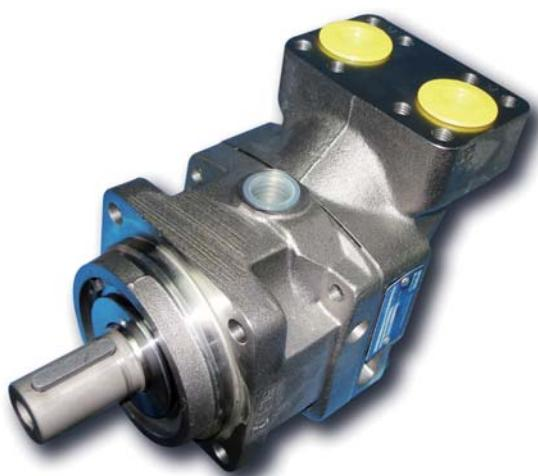
La serie F12 es una bomba-motor con eje en ángulo y caudal fijo para aplicaciones fuertes. Puede emplearse tanto en aplicaciones de circuito abierto como en circuito cerrado. Cumple con las normas ISO y SA sobre brida de montaje y eje. También disponible en versión tipo cartucho, con una longitud de instalación reducida.
