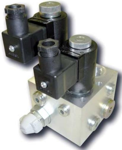
Distribuidor eléctrico destinado a vehículos ligeros-medios. Con un caudal máximo de 40L, es capaz de regular la velocidad de bajada del volquete, además ofrece la posibilidad de montar directamente sobre nuestra gama de depósitos de aceite. Incluye en opción el kit de montaje eléctrico completo (cableado, relé, avisador y final de carrera eléctrica).
